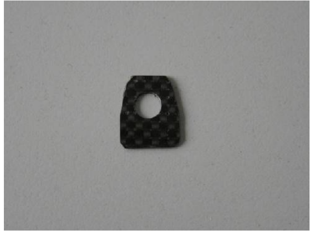
UFM Buchse Halterung aus Laminatreste
