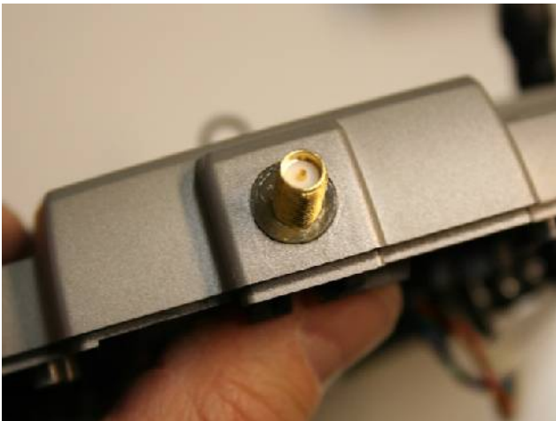
Hier andere Lösung mit eingearztter GFK Scheibe bei nur Duplex Lösung
